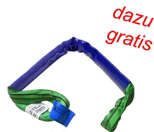
Zuggurt aus Polyester Länge: 1000 mm Durchmesser: 45 mm Belastbarkeit: 5 ton. einfach / 10 ton. in U-Form
